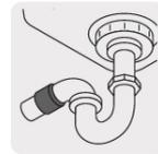
Para conectar el tubo del céspol de lavabo o fregadero al desagüe del muro
