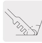
Ángulo de corte de 100° permite cortar vidrios de hasta 6 mm
