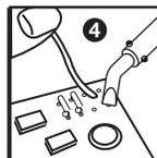
Caliente la superficie a soldar, no la soldadura
